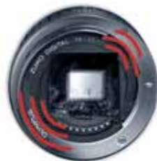
Активация ультразвукового волнового фильтра: пылинки стряхиваются
